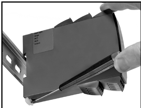
Abbildung 1: Das Modul wird von der DIN-Schiene gelöst, indem man den unteren Verschluss löst.
